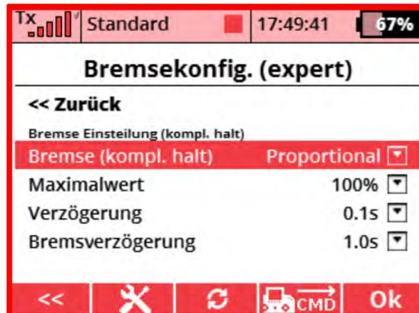
**Maximale Bremse** - Der Parameter ist im Bereich von 10-100 % einstellbar. Bestimmt die Bremswirkung des Motors, wenn sich der Gasknüppel in der Minimalposition befindet.
