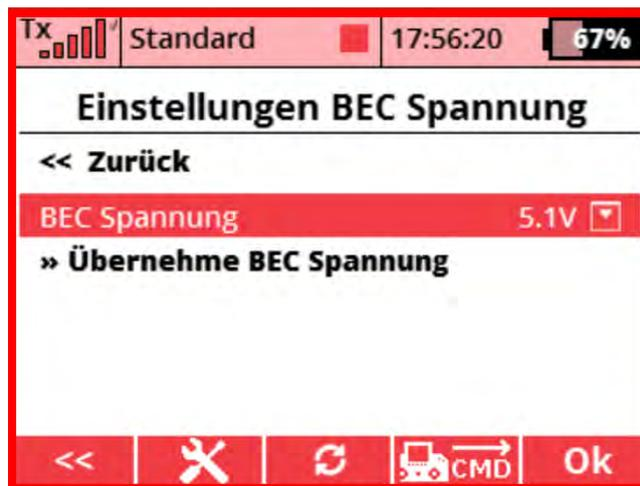
**BEC** = Spannungsstabilisierungs-Schaltung für die Versorgung der RC Anlage aus dem Antriebsakku. Bei der MEZON EVO Serie ist ein getaktetes BEC mit folgenden Eigenschaften verbaut:
