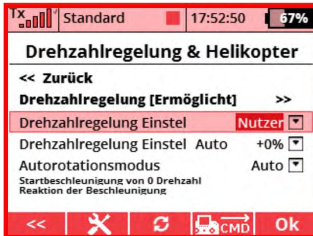
**Hinweis:** Wenn ein erhöhter Wert von „Auto+xx“ zu Drehzahlschwankungen führt, bedeutet dies, dass die Reglereinstellung zu „hart“ ist und der Regler seine Instabilitätsgrenze erreicht hat. Es ist notwendig, den Wert von „Auto+xx“ wieder auf einen stabilen Wert zu verringern.
