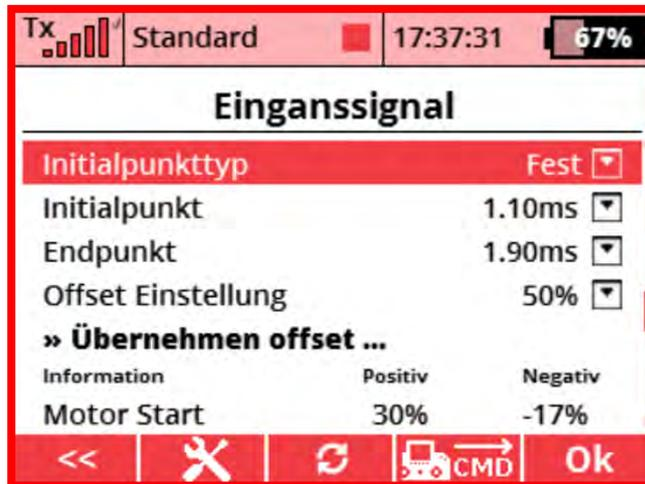
**Hinweis:** Der "Initial Punkt" Wert muss auf einen höheren Wert eingestellt werden als der Drosselkanal im Moment des Einschaltens ausgibt. Wenn diese Bedingung nicht erfüllt ist, startet der Motor nicht.
