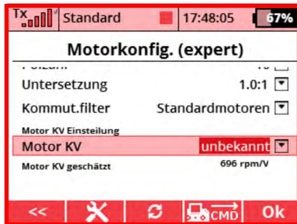
Es ist auch möglich „Motor KV“ – „unbekannt“ zu wählen. Der Regler versucht den KV-Wert während des Motorlaufs zu ermitteln und zu berechnen. Dieser Schätzwert wird in der Zeile KV-Schätzung angezeigt.
