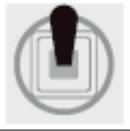
Den Regler mit dem Akku verbinden, 2 Sek. warten, wenn der Motor zwei kurze „BEEP BEEP“ Signale (♪, ♪) ausgibt, ist die Vollgasposition gespeichert.
