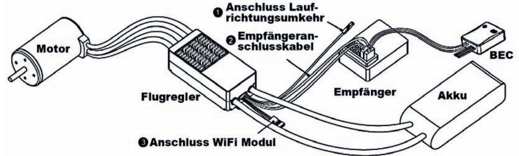
Bitte stellen Sie sicher, dass alle Lötstellen mit Schrumpfschlauch isoliert sind. Das Bild zeigt einen Referenzregler.
