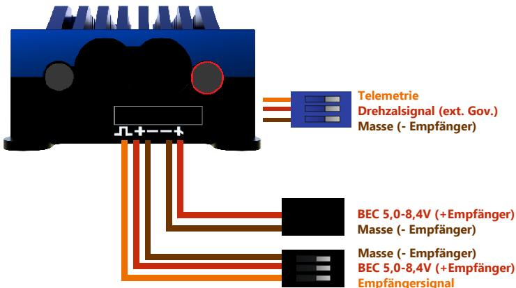
In der Regel werden die Signal- und BEC-Kabel im Heli von vorne nach hinten am Motor vorbei verlegt. Bitte beachten Sie dabei, dass die Empfänger-, Telemetrie- und BEC-Kabel gebündelt auf einer Seite entlang geführt werden müssen!
